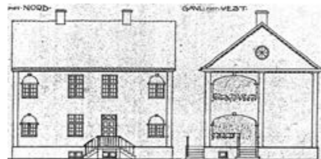
Skogliveien 41 ble bygd som funksjonær bolig for Drammens Elektrisitetsverk i 1923. Byarkitekt Alf Bugge utformet huset i samarbeid med Martin Simonsen. Bygningen fikk originale vindusløsninger og innebygde verandaer mot vest. Trekantgavlene ble utstyrt med tannsnitt og hjulvinduer.
