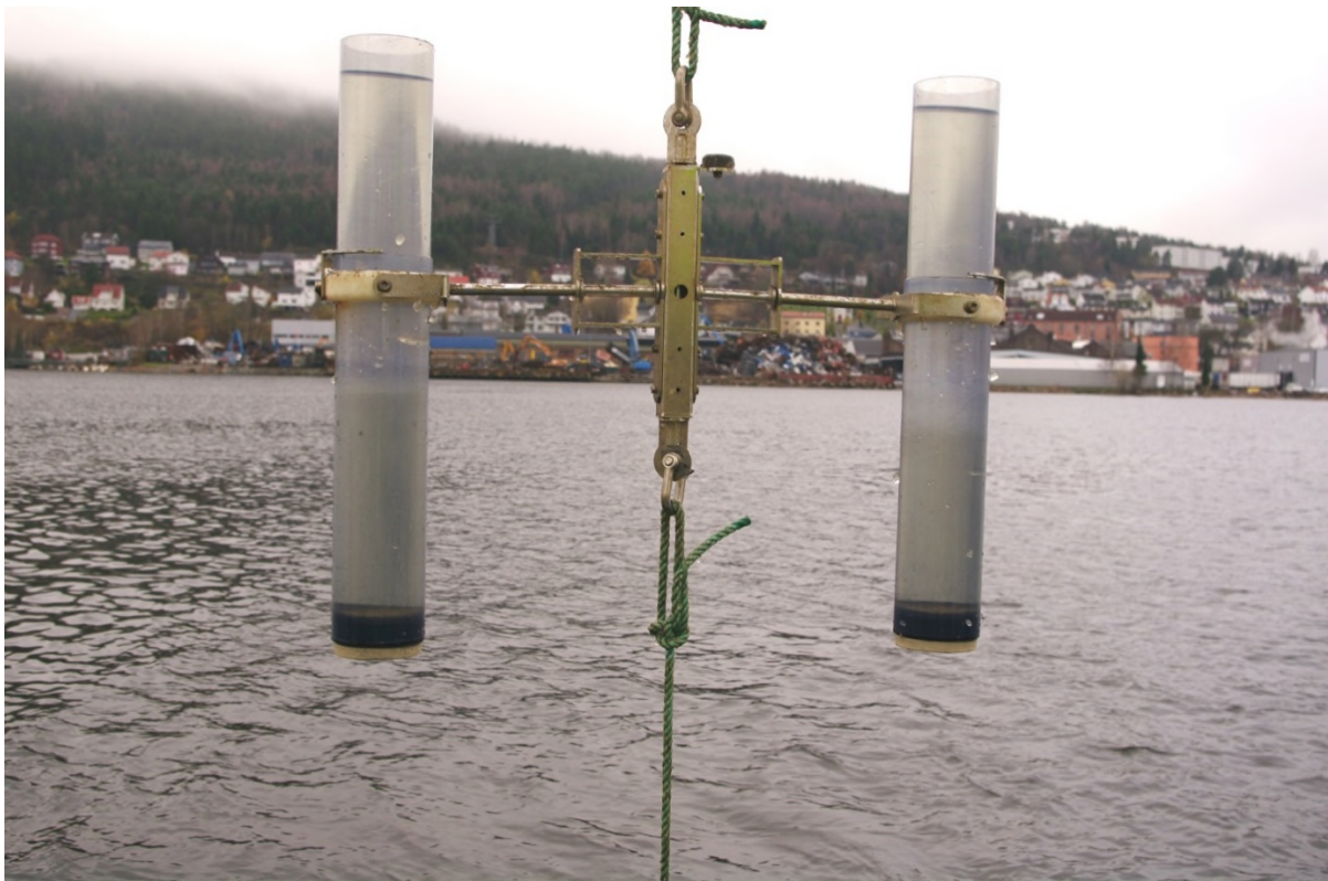
Figur 2. Eksempel på sedimentfelle brukt i Indre Drammensfjord (foto: Jane Dolven, Norconsult).
