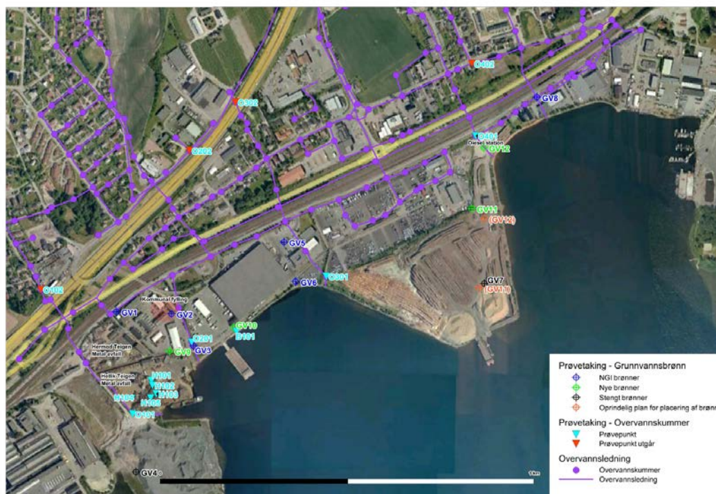
Figur 9: Overvannssystem og prøvetakingskummer fra COWI 2012.
